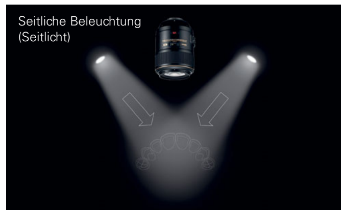
Abb. 4 Eine seitliche Beleuchtung definiert die Form eines Objekts besser und wirft einen partiellen Schatten, so dass das Bild dreidimensionaler wirkt
