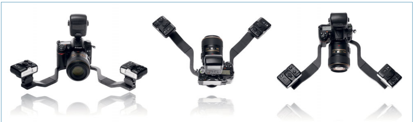
Abb. 14 Der Achsenhalter (Nachbildung) ermöglicht ein fixiertes Bild mit seitlicher (45°/0°) Beleuchtung bei leichtem Gewicht
