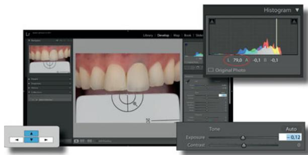
**Abb. 8** Die gemessenen  $L^*$ -,  $a^*$ - und  $b^*$ -Werte werden unter dem Histogramm angezeigt, wenn der Lupen-Cursor an einer Stelle gehalten wird. Mit den Pfeil-nach-oben- und -nach-unten-Tasten wird die Belichtung kompensiert, bis der bekannte Helligkeitswert ( $L^* = 79$ ) der Graukarte reproduziert ist (d. h. -0,12).
