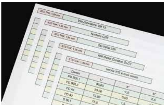
Fig. 11 Les tableaux d'interpolation sont élaborés en se fondant sur les coordonnées CIE L*a*b* des systèmes céramiques les plus courants, ainsi que sur des épaisseurs de recouvrement standard. Ces tableaux permettent de déterminer la couleur dentine du système céramique la plus appropriée et indiquent les proportions des mélanges à effectuer pour augmenter, si nécessaire, a* ou b*, ou réduire la luminosité.
