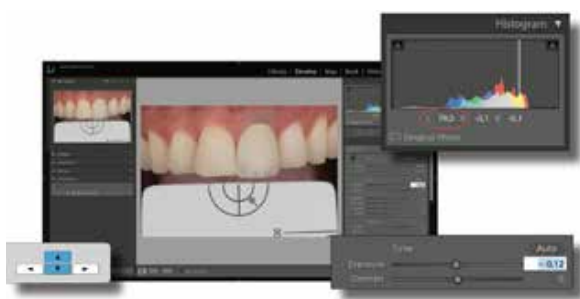
Fig. 8 Les valeurs L^*a^*b^* s'affichent dès que la loupe garde sa position. Les flèches « haut » et « bas » du clavier servent à ajuster l'exposition de l'image. Ce réglage est effectué jusqu'à l'obtention de la valeur connue ( L^* 79 ) de la luminosité de la carte grise de référence (ici : - 0,12).
