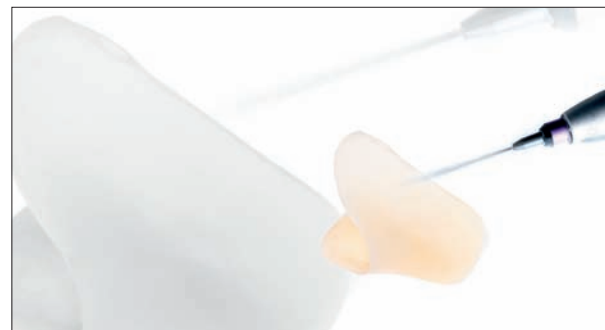
図 43 フレームシェード NT の焼成後、焼成用セラミックスとの良好な結合を得る目的で、フレーム外側に若干のサンドブラスト処理を施す
